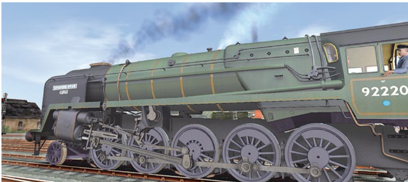
Hoch stehender Kessel und deswegen schrägangeordnete Zylinder-daran erkennt man die 9f!
