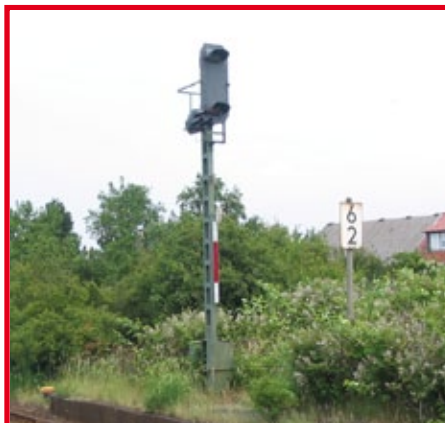
Hauptsignal der Bauart 1951 in der Variante Einfahr-/Blocksignal. Es gibt je eine Optik für rot, grün und gelb sowie ein Notrot, das bei Ausfall der normalen roten Lampe aktiviert wird.
